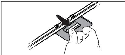
**Filtro al carbón activo NO lavable** - La saturación del **carbón activado** ocurre después de más o menos tiempo de uso prolongado, dependiendo del tipo de cocina y de la regularidad de limpieza del filtro de grasa. En cualquier caso es necesario sustituir el cartucho al menos cada 4 meses. NO puede lavarse o reciclarse.
