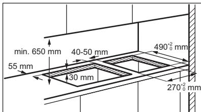
Kui samasse väljalöigatud avasse üksteise kõrvale soovitakse paigutada mitu 30 cm pliidiplaati, võib volitatud teeninduskeskusest hankida külgoendiga paigalduskomplekti ja täiendavad tihendid. Komplektiga on kaasas ka spetsiaalsed paigaldusjuhised.
