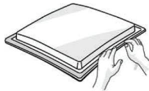
Установите варочную панель в выемку в столешнице, вырезанную по размерам, указанным в Руководстве.
