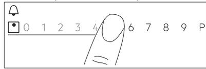
Sildīšanas pakāpi var mainīt arī gatavošanas laikā. Pieskarieties zonas izvēles simbolam vadības paneļa galvenajā skatījumā un parvietojiet pirkstu pa kreisi vai pa labi (lai pazeminātu vai paaugstinātu sildīšanas pakāpi).
