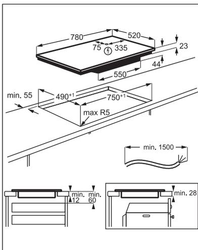
**i** Si l'appareil est installé au-dessus d'un tiroir, la ventilation de la table de cuisson peut chauffer les éléments rangés dans le tiroir durant la cuisson.
