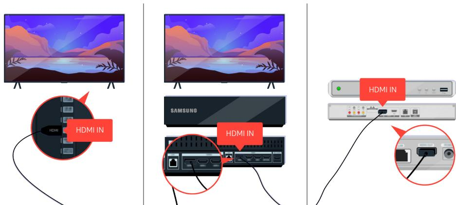
Ja šī problēma atkārtojas, mēģiniet televizoram pievienot citu ārējo ierīci, izmantojot HDMI kabeli. Ja televizors rāda attēlu pareizi, ārējā ierīce var būt bojāta.
