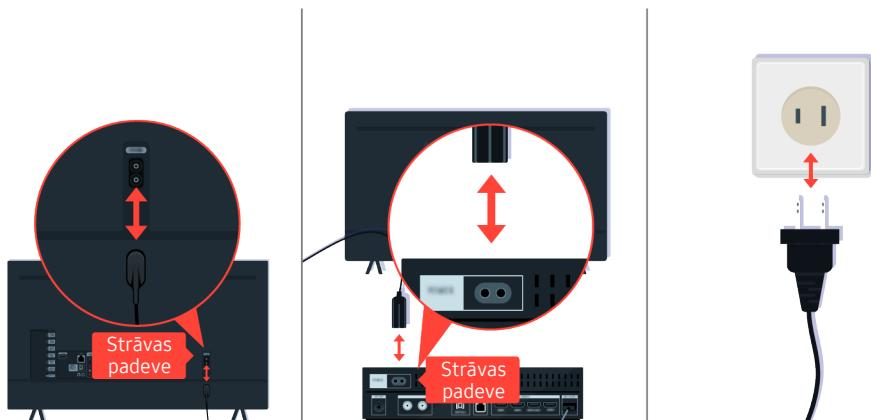
Vispirms atvienojiet un atkārtoti savienojiet barošanas kabeļus un HDMI kabeļus televizora vai One Connect (OC) Box aizmugurē, pēc tam atvienojiet barošanas kabeli un iespraudiet to atpakaļ sienas kontaktligzda.
