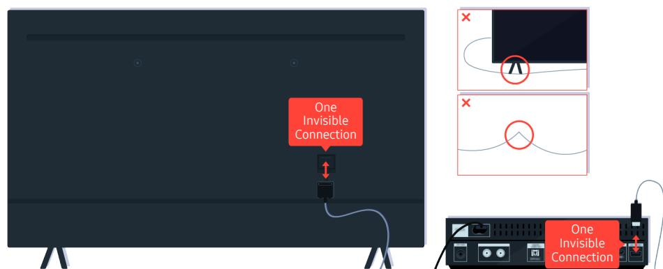
Atvienojiet un pievienojiet vēlreiz One Invisible Connection kabeli starp televizoru un One Connect (OC) vadības bloku. Pārbaudiet, vai One Invisible Connection kabelis nav saspiests vai saliekts asā lenķī.
