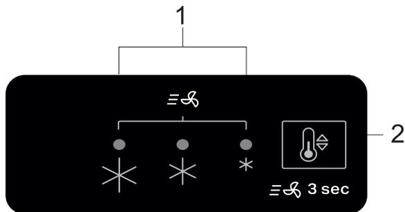
1. Indikatoru gaismiņas (lai attēlotu pašreizējos temperatūras uzstādījumus vai Ātrās saldēšanas funkciju)
