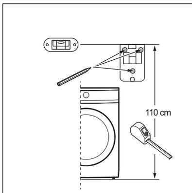
b. Använd en nivå för att kontrollera att de tre borrhåstansarna är vågräta och väl inriktade före borrhugg.
