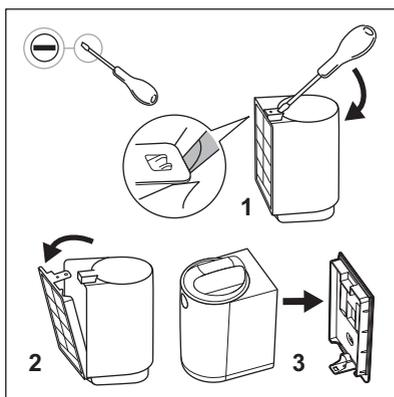
1. Extrae el filtro de su caja de embalaje y retira el soporte de pared con un destornillador plano.
