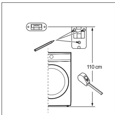
b. Utilizați o nivelă cu bulă de aer pentru a verifica dacă cele 3 puncte de forare sunt drepte și bine aliniat înainte de găurire.
