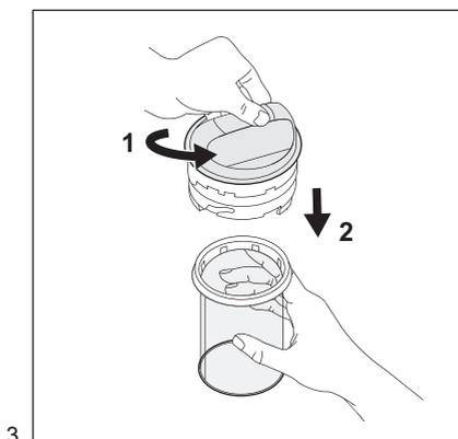
Filtr otevřete pomocí pohybů znázorněných na obrázcích 1 a 2:
