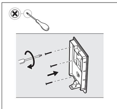
**4. Закрепите настенный держатель с помощью прилагаемых винтов и пластмассовых анкеров. Убедитесь, что он установлен прямо и надежно прикреплен к стене.**
