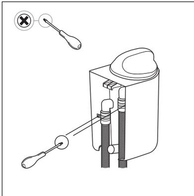
Achten Sie bei der Verwendung des Schraubendrehers darauf, dass Sie das Filtergehäuse und die Schläuche nicht beschädigen.
