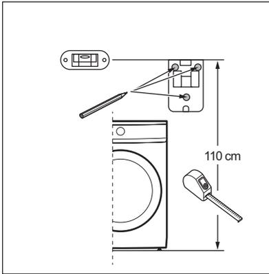
б. С помощью уровня проверьте, что три лунки для сверления выровнены и правильно размещены относительно друг друга.
