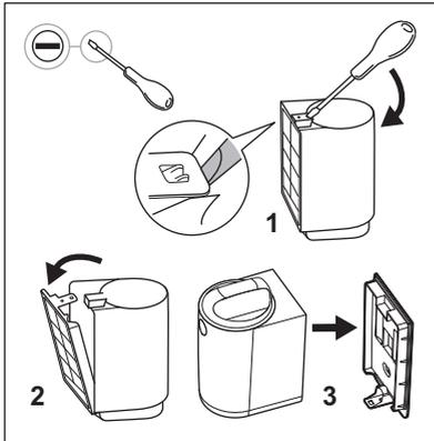
**1. Αφαιρέστε το φίλτρο από το κουτί συσκευασίας και αφαιρέστε το στήριγμα τοίχου με τη βοήθεια ενός κατασαβιδιού με επίπεδη μύτη.**
