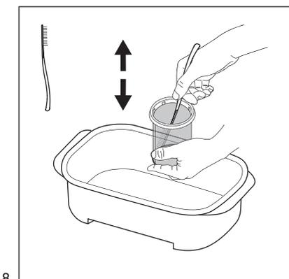
Afferrando la cartuccia all'interno del contenitore, utilizzare la spazzola-spatola in dotazione nella scatola del filtro. Con un movimento della spazzola verso l'alto e il basso, rimuovere quante più fibre possibili rimaste attaccate alla rete della cartuccia per facilitare la fuoriuscita dell'acqua.
