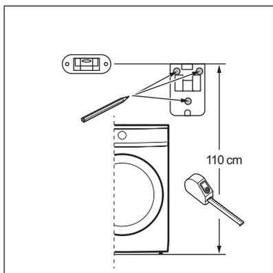
b. Utilisez un niveau pour vérifier que les 3 poinçons de forage sont à niveau et bien alignés avant le forage.
