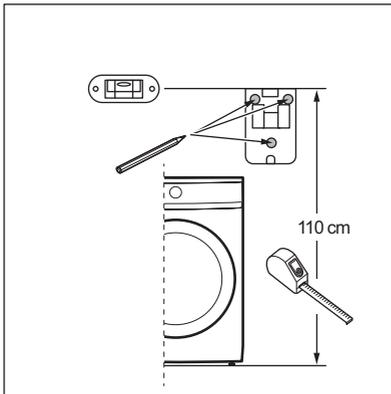
b. Prüfen Sie vor dem Bohren mit einer Wasserwaage, ob die 3 Bohrstempel waagrecht und gut ausgerichtet sind.
