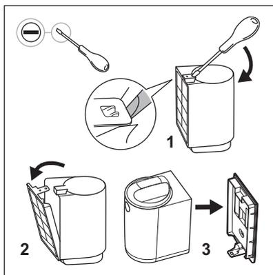
1. Ta ut filtret ur förpackningen och ta bort väggstödet med hjälp av en platt skruvmejsel.
