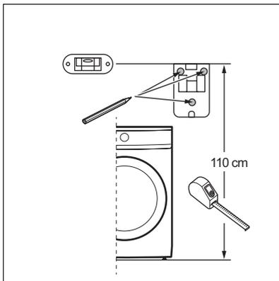
b. Před samotným vrtáním použijte vodováhu k ověření toho, zda jsou umístění 3 vrtaných otvorů dobře zarovnána, vodorovně i svisle.
