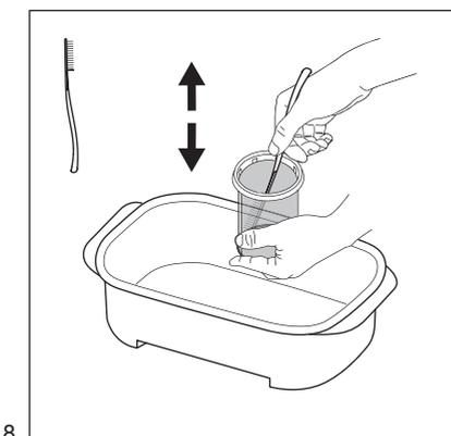
Κρατώντας τη φύσιγγα μέσα στο δοχείο, χρησιμοποιήστε το εργαλείο ψύκτρας-σπάτουλας που διατίθεται στο κουτί του φίλτρου. Με την κίνηση της βούρτσας πάνω/κάτω αφαιρέστε όσο το δυνατόν περισσότερο τις ίνες που είναι προσαρτημένες στο δίχτυ της φύσιγγας για να διευκολύνετε την εκκένωση του νερού.
