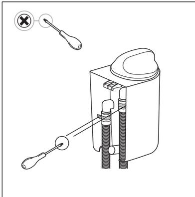
Quando utilices el destornillador, ten cuidado de no dañar la carcasa del filtro ni las mangueras.
