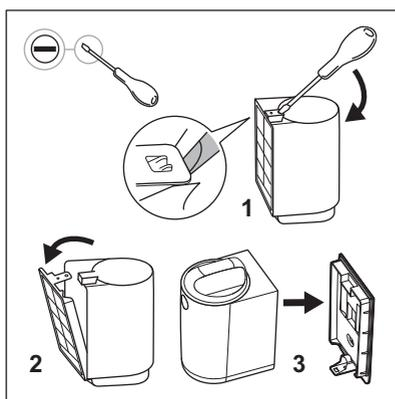
1. Izvadite filtar iz ambalaže i pomoću ravnog odvijača uklonite zidni nosač.
