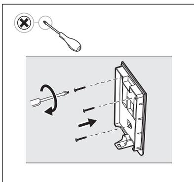
**4. Bevestig de wandsteun met de meegeleverde schroeven en plastic ankers en zorg ervoor dat deze recht en stevig aan de wand is bevestigd.**
