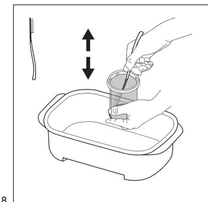
Halten Sie die Patrone in den Behälter und verwenden Sie das in der Filterbox enthaltene Pinsel-Spatel-Werkzeug. Durch Auf- und Abwärtsbewegungen der Bürste werden die am Patronennetz haftenden Fasern so weit wie möglich entfernt, um das Abfließen des Wassers zu erleichtern.
