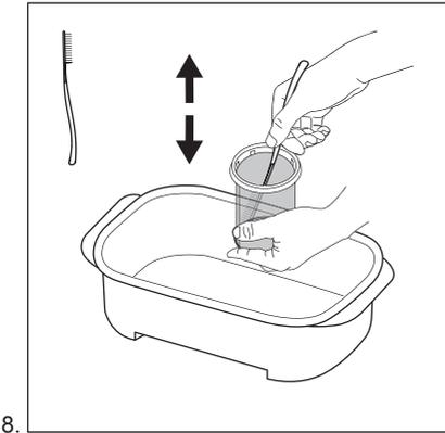
Sosteniendo el cartucho dentro del recipiente, utiliza la el cepillo-espátula que hay en la caja del filtro. Moviendo el cepillo arriba y abajo, retira lo máximo posible las fibras adheridas a la malla del cartucho para facilitar la evacuación del agua.
