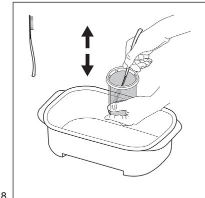
Gebruik, terwijl u de patroon in de filterhouder houdt, het borstel/spatel-hulpstuk die meegeleverd wordt in de filterdoos. Verwijder met een op- en neergaande borstelbeweging zoveel mogelijk alle vezels die aan de cassette vastzitten om zo de afvoer van water te bevorderen.
