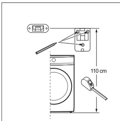
b. Χρησιμοποιήστε ένα επίπεδο για να ελέγξετε ότι οι 3 διατρήσεις είναι οριζοντιωμένες και καλά ευθυγραμμισμένες πριν από τη διάτρηση.
