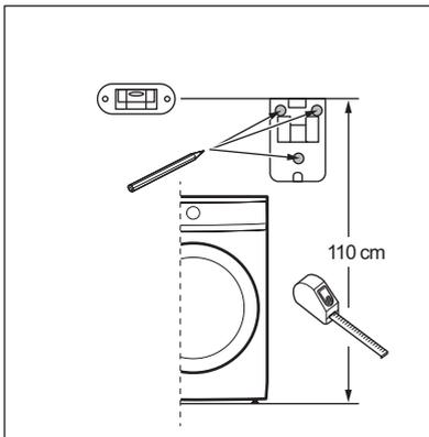
b. Utiliza un nivel para comprobar que los 3 puntos de taladro estén nivelados y bien alineados antes de perforar.
