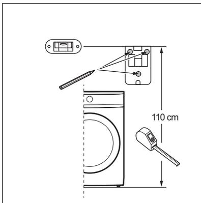
б. Перед свердлінням переконайтеся, що 3 відмітки для свердління розташовано рівномірно й на відповідній висоті, за допомогою покажчика рівня.
