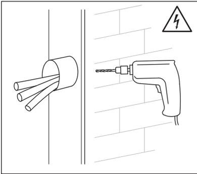
**3. Perfora los orificios en la pared e inserta los tacos.**
