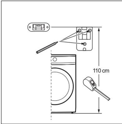
b. Gebruik een waterpas om te controleren of de 3 te boren gaten waterpas zijn en goed zijn uitgelijnd voordat u gaat boren.
