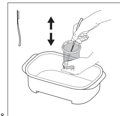
Утримуючи картридж усередині контейнера, скористуйтеся щіткою-лопаткою, розташованою в коробці з фільтром. Рухаючи щітку вгору/вниз, максимально видаліть волокна, що застрягли на сітці картриджа, щоби сприяти зливанню води.
