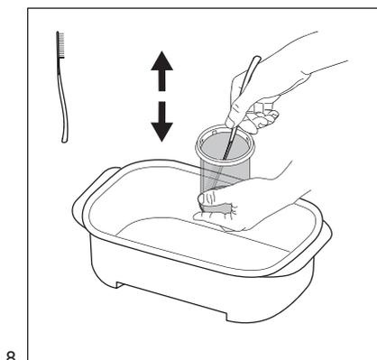
Hold patronen inde i beholderen og brug det børstespatelværktøj, der findes i filterkassen. Med op/ned-børstebevægelse fjernes så meget af fibrene, der er fastgjort til patronnettet, for at hjælpe med at tømme vandet.
