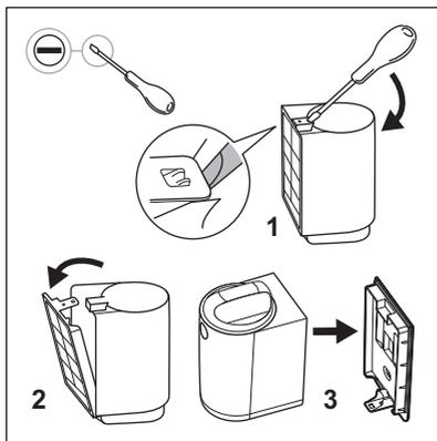
1. Verwijder het filter uit de verpakking en verwijder de wandsteun met behulp van een platte schroevendraaier.
