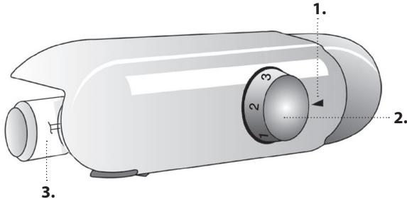
1. Ponto de referência para controlo do termostatoTemperatura dos compartimentos do congelador e do frigorífico
