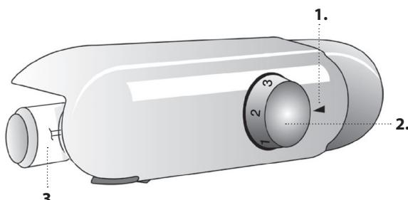
1. Ενδεικτική εγκοπή για τη θέση του θερμοστάτη θερμοκρασία θαλάμου καταψύκτη και ψυγείου
