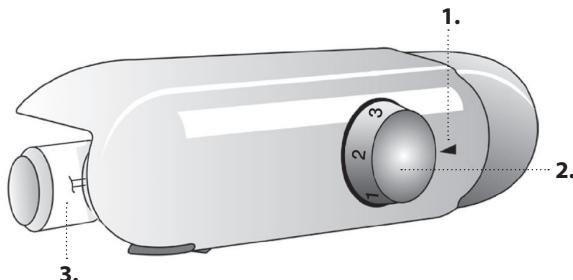
1. Referencia del control del termostatoTemperatura del compartimento frigorífico y congelador
