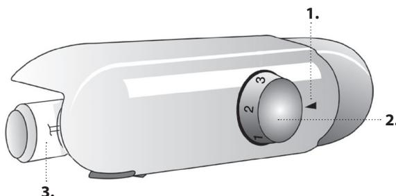
1. Znak za određivanje položaja termostataTemperatura hladnjaka i zamrzivača
